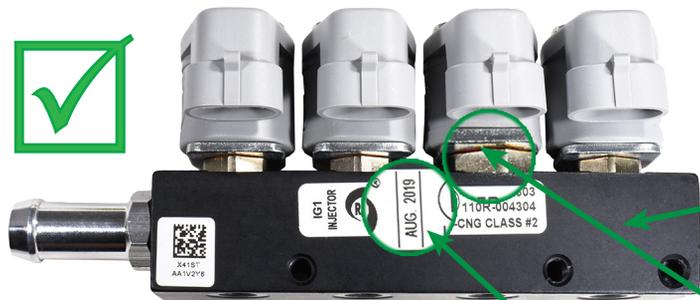
Оригинальная рейка IG1 имеет гладкий матовый корпус, приятный на ощупь. Корпус подделки блестящий, шершавый, со следами механической обработки на торцах.
