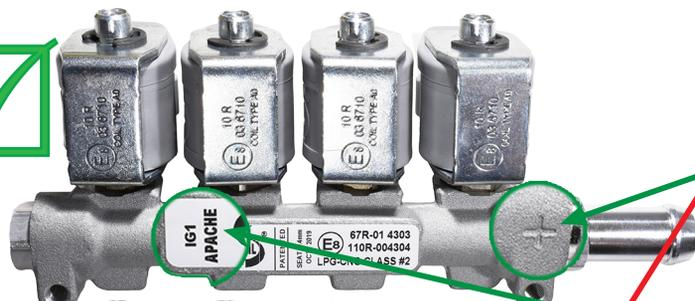
На корпусе оригинальной рейки IG1 Apache выдавлен объемный знак «+». На корпусе подделки он отсутствует.
