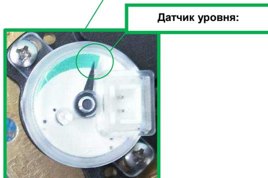
Рисунок 20. Проверка датчика уровня
