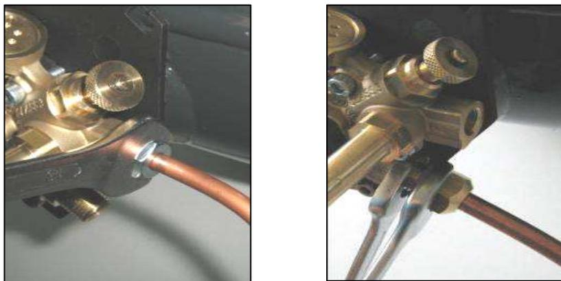
**Рис. 37: Затяжка фитингов для тороидальных баллонов 0°**
