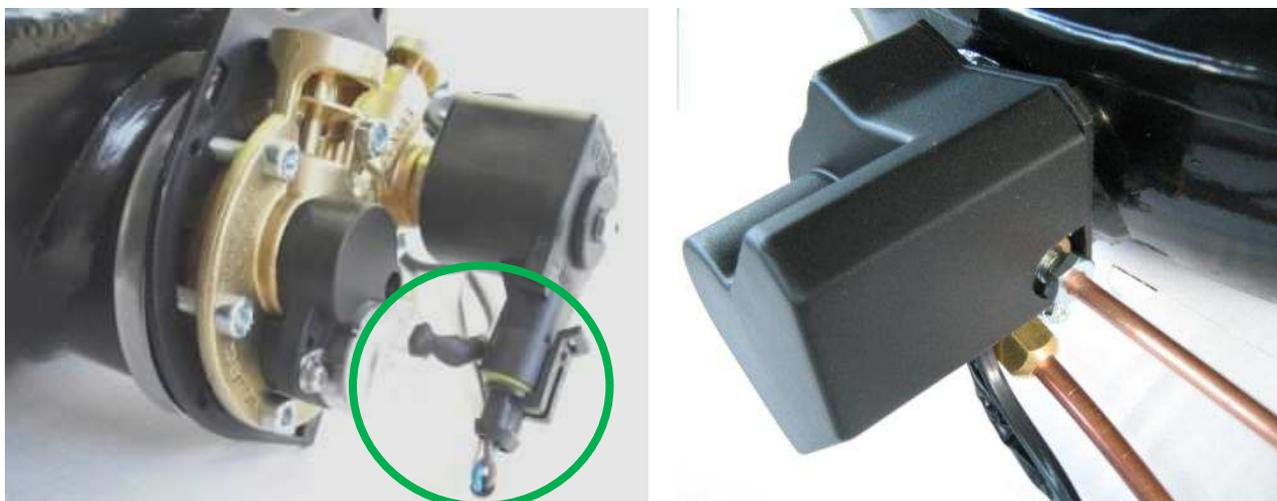
**Рис. 38: тороидальный баллон 0°: электрические соединения и установка защитного кожуха**
