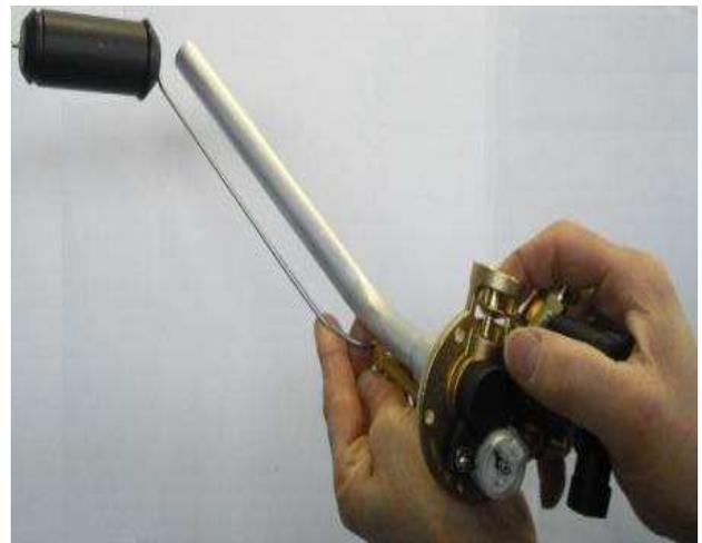
Иллюстрация 7: проверка поплавка
