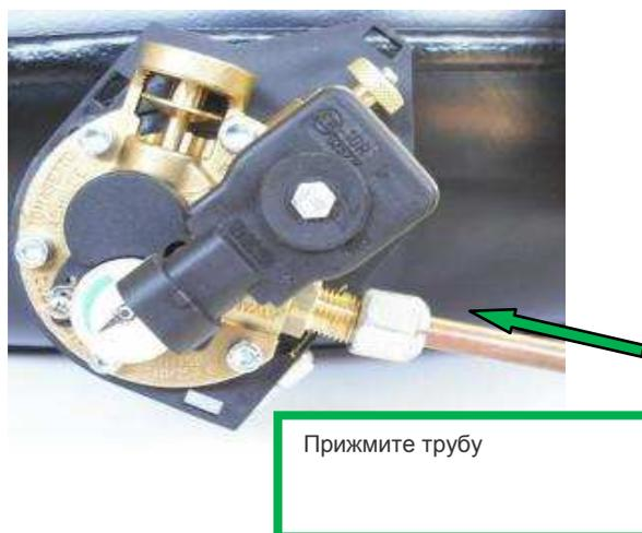
Рис. 27. Присоединение трубки к мультиклапану
