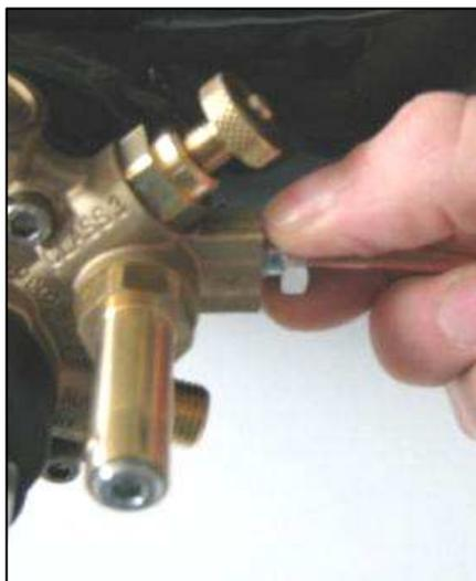
Рис. 2. Присоединение трубки к мультиклапану
