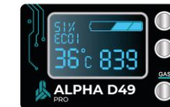
Двигатель запущен. Режим ГАЗ, настройка "ЭКО 1".
