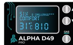
Двигатель запущен. Режим ожидания перехода на газ.
